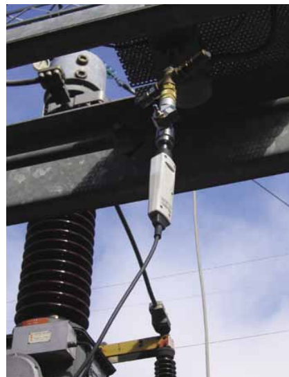
维萨拉的DM70手持式测量仪是测量六氟化硫(SF6)气体露点的理想仪表。
